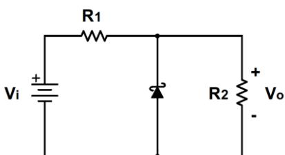
35. (D)根據以下電路， $V_i=18$  V， $R_1=1\text{K}\Omega$ ， $R_2=2\text{K}\Omega$ ，稽納二極體(Zener Diode)的崩潰電壓為 8V，問通過稽納二極體的消耗功率為多少？ (A) 0mW (B) 12mW (C) 36mW (D) 48mW
