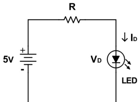
50. (C)根據以下電路，二極體為理想二極體，試求電流 I 是多少？ (A) 0mA (B) 4mA (C) 4.5mA (D) 5mA
